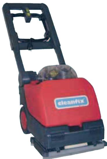
Handliche Scheuersaugmaschine für alle Hartböden im Haushalt und Kleingewerbe. Zwei Tellerbürsten fegen gründlich den Boden, wobei der losgelöste Schmutz sofort mittels Sauglippen abgesaugt wird. Vor- und rückwärts Arbeiten möglich. Abklappbarer, höhenvariabler Teleskopbügel für ergonomisches Arbeiten, im abgeklappten Zustand leicht zu verstauen.
