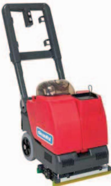
Scheuersaugmaschine RA 320 IBC. Batterieversion mit 12 Liter Wassertank. Diese absolut wendige und handliche Scheuersaugmaschine ist speziell für die perfekte Reinigung aller Hartböden in zB. Garderoben und kleineren Flächen konzipiert worden. Zwei Tellerbürsten scheuern gründlich und der gelöste Schmutz wird im gleichen Arbeitsgang abgesaugt. Vor und rückwärtsarbeitend.
